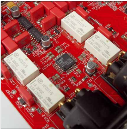
Anstatt den Schalldruck im DAC zu regeln, kommt eine eigene analoge Lautstärkekontrolle zum Einsatz
