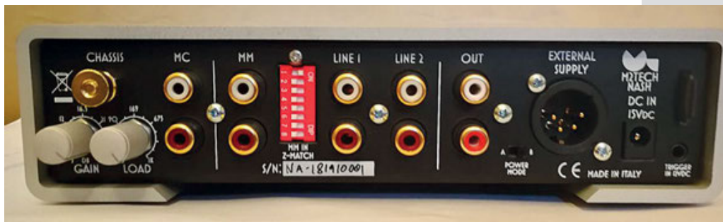
L'ingresso MC è affiancato dal potenziometro LOAD per la regolazione fine del carico.
