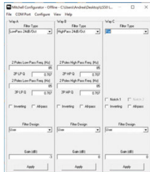
Figura 1. L'interfaccia utente del software Mitchell Configurator è sobria e intuitiva. Si può dare sfogo alla propria fantasia tra passa-alto, basso, filtri notch e passa-banda, pendenze fino a cinque poli, fattori di merito, inversioni di fase e guadagno personalizzato ma anche selezione diretta di tipologie di reti come Butterworth, Bessel e Chebychev.
